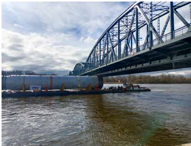
TRANSPORT ŁADUNKÓW WIELKOGABARYTOWYCH NA ODCINKU GDAŃSK-PŁOCK PROWADZONY CYKLICZNIE W 2023 R. NA ZDJĘCIU PRZEJŚCIE ZESTAWU PCHANEGO POD MOSTEM DROGOWYM IM. JÓZEFA PIŁSUDSKIEGO W TORUNIU. BYŁ TO TRANSPORT ELEMENTÓW (NA ZDJĘCIU POTĘŻNA, WAŻĄCA PONAD 800 TON KOLUMNNA WASH TOWER) DO BUDOWY NOWOCZESNEGO KOMPLEKSU OLEFIN III NA TERENIE NALEŻĄCEJ DO ORLENU PETROCHEMII W PŁOCKU
